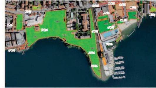
La mappa mostra per ciascuna area verde della città di Lugano la sua percentuale di capacità di infiltrazione.
